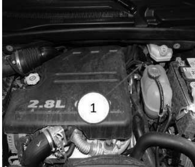
Fig. 1 Einbaulage des Differenzdrucksensors im Motorraum
